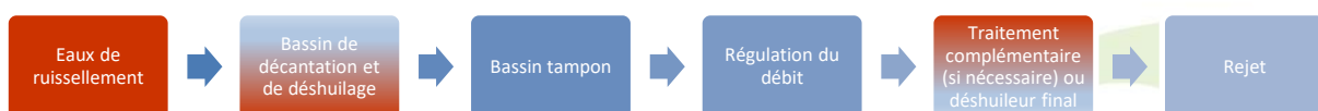
Figure 1 : schéma de la filière de traitement à prévoir pour les eaux de ruissellement
