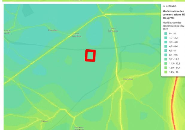
Figure 33 : Modélisation des concentrations en NO2 - zone d'implantation du Projet (source : ATMO HDF)
