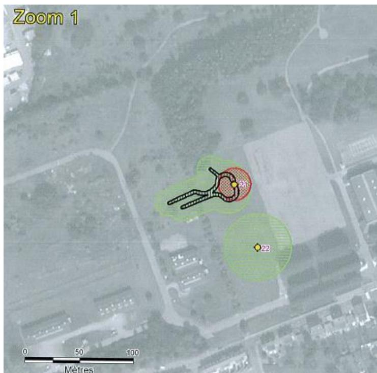
Le puits de mine n°21 est concerné par un aléa fort de risque d'effondrement localisé et par un risque de tassement faible aux alentours des anciennes galeries. Le puits n°22 est concerné par un risque de tassement faible.
